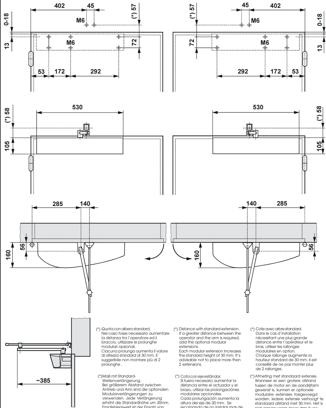
Quote in mm · Dimensions in mm · Cotes en mm · Maßangaben in mm · Cotas en mm · Afmetingen in mm
