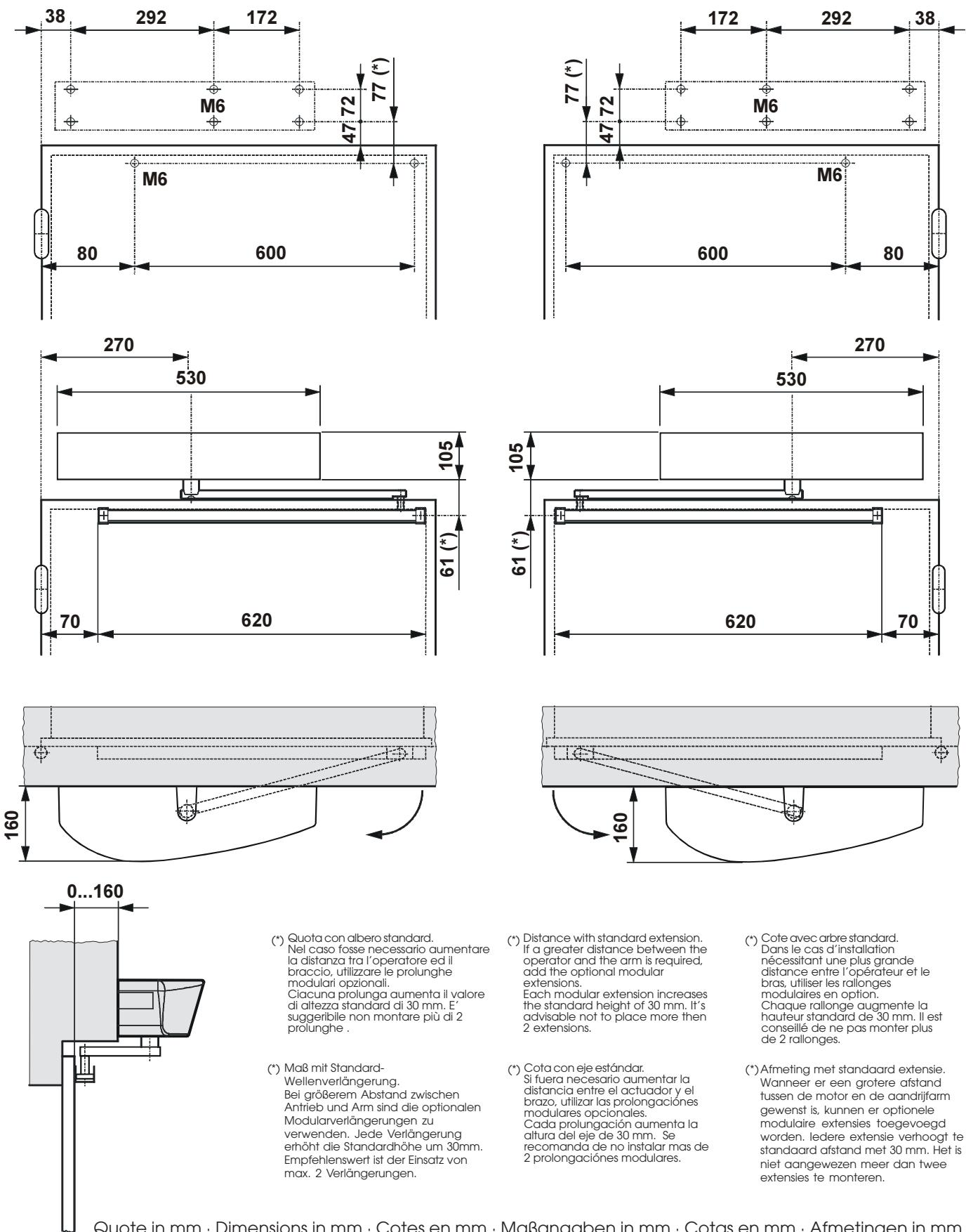
Tav.D : MONTAGGIO SULL'ARCHITRAVE (BRACCIO A PATTINO L=430mm) · Table A: LINTEL MOUNTING (SLIDING ARM L=430mm)
