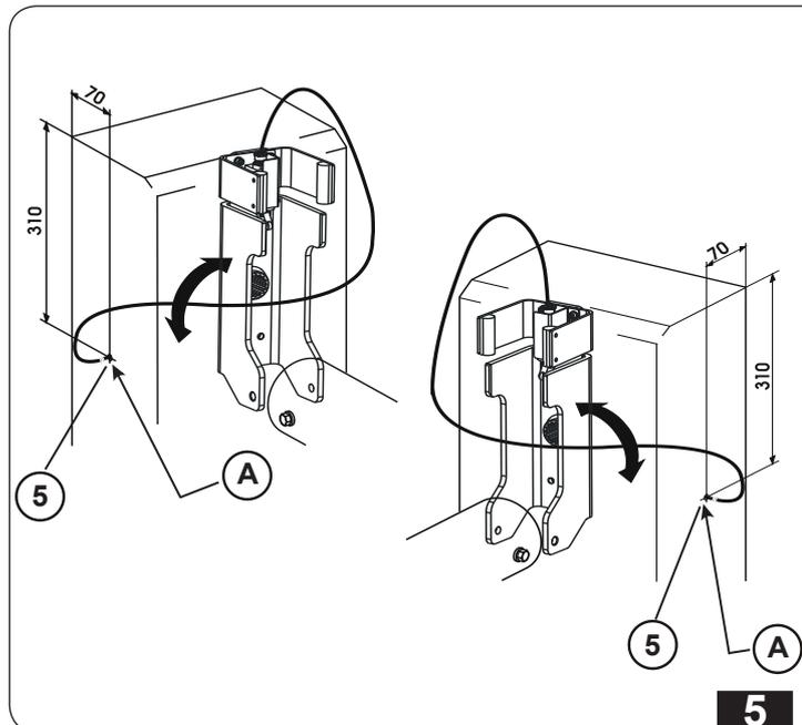
**I-FISSAGGIO CAVO:** Praticare un foro di 10 mm. nella posizione A, rispettando il senso di rotazione dell'asta, per il passaggio del cavo precablato, utilizzando il passacavo fornito (rif. 5). Collegare il contatto del micro interruttore al connettore J6 dell'apparecchiatura 624BLD.
