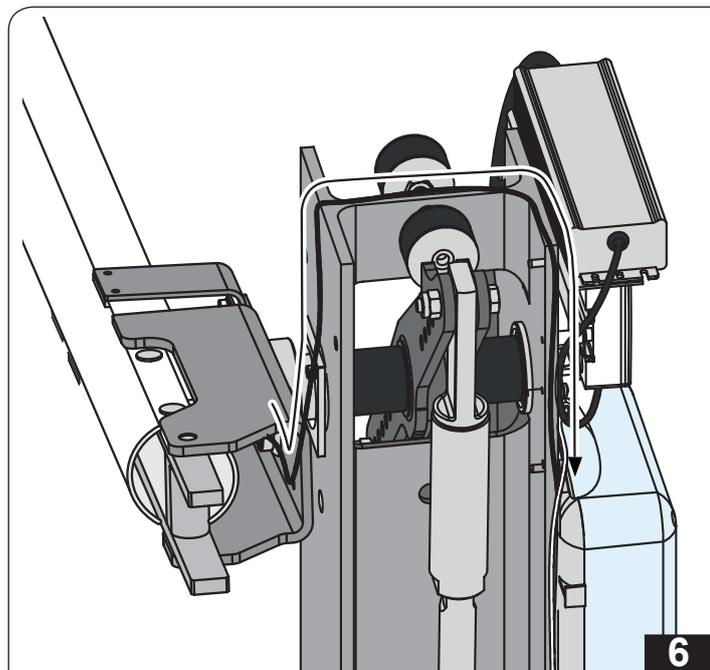
**I-FISSAGGIO CAVO:** Assicurare il cavo di collegamento secondo il percorso indicato, utilizzando le predisposizioni per l'inserimento di fascette di fissaggio ricavate sul montante. Collegare il contatto del micro interruttore al connettore J11 dell'apparecchiatura B680H.
