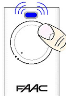
6. Die weiterzugebende Kanaltaste am „Master“ drücken und festhalten. Die LED leuchtet dauerhaft
