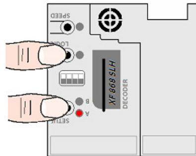
4. Taste LOGIC drücken und halten; danach die Taste SETUP drücken und halten (quasi beide gleichzeitig) – Die LED „A“ beginnt zu blinken.
