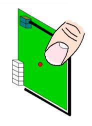
5. Die Programmiertaste an der RP- Platine drücken und festhalten. Die LED an der Platine leuchtet, geht aus und wieder an.
