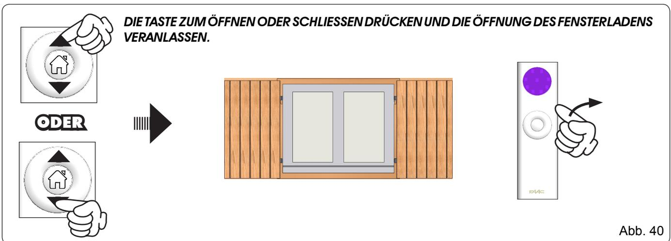
**ZWEI SEKUNDEN LANG DIE STOPPTASTE DRÜCKEN, SIE DANN EINE SEKUNDE LANG LOSLASSEN UND ERNEUT DRÜCKEN UND GEDRÜCKT HALTEN, BIS DIE ANGEGEBENEN BEWEGUNGEN BEENDET SIND, UM DIE BESTÄTIGUNG DER ERFOLGTEN SPEICHERUNG DES ENDSCHALTERS FÜR DIE ÖFFNUNG ZU ERHALTEN.**
