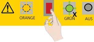
Wenn ein DIP-Schalter geändert wurde, blinkt die LED orange. Betätigen Sie den Drucktaster länger als 3 Sekunden um die Einstellung zu bestätigen. Anschließend wird durch grünes Blinken (x) die Anzahl der angeschlossenen Module angezeigt.
