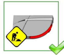
Den Laserfensterschutz bis nach Ende der Bauarbeiten nicht entfernen.
